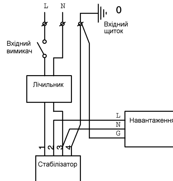
Схема підключення стабілізатора до однофазної мережі.
